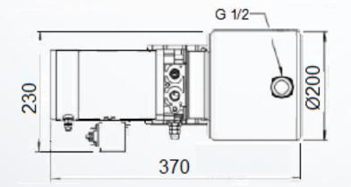
ELECTRIC MOTOR Power: 2,2 kW
